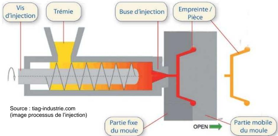
L'étude de la température au cours du refroidissement est capitale car elle permet de déterminer la durée optimale d'un cycle. Pour le polystyrène, une température de 70 °C est préconisée lors de l'éjection pour éviter tout risque de défaut de surface.
